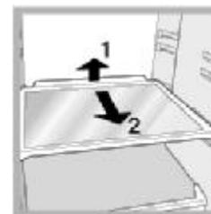
**ПОЛКИ\***: решетчатые или сплошные. Полки съемные, их высоту можно регулировать благодаря специальным направляющим (см. рис.), что позволяет свободно размещать на полках большие емкости и крупные продукты. Можно регулировать высоту полки, не вынимая ее полностью.
