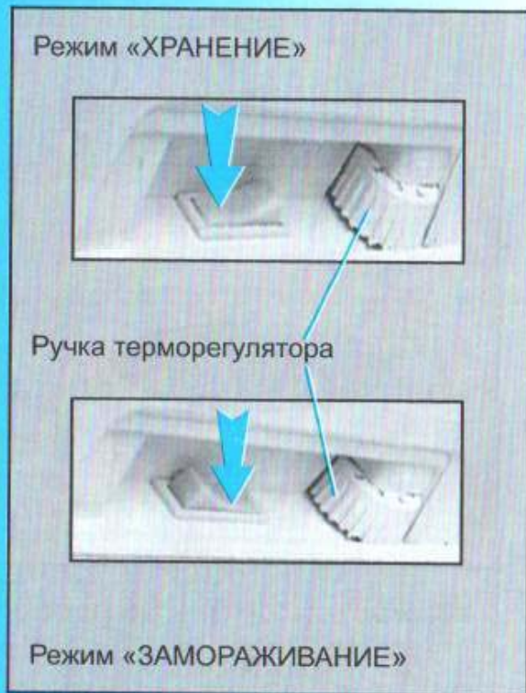
Рисунок 5 - Схема расположения переключателя режимов
